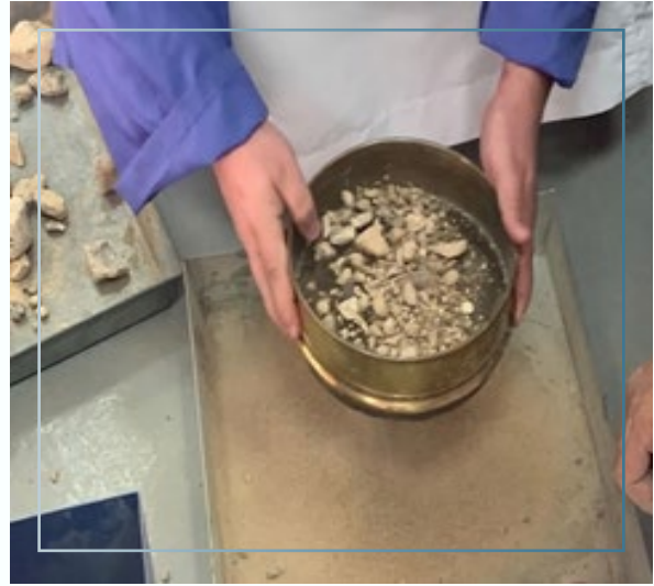
شكل رقم (2): اختبار التدرج الحبيبي Sieve Analysis
