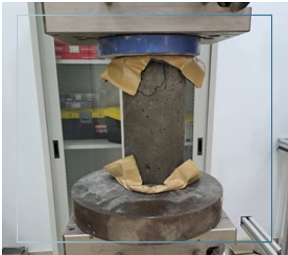
شكل رقم (7): تكسير العينات الخرسانية بجهاز Universal Test Machine
