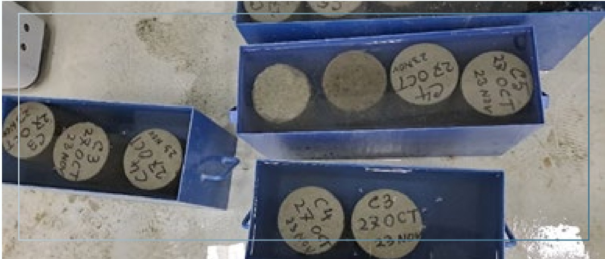
شكل رقم (6): الاسطوانات الخرسانية أثناء المعالجة
