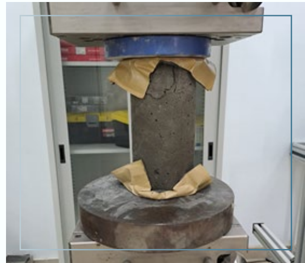
شكل رقم (7): تكسير العينات الخرسانية بجهاز Universal Test Machine
