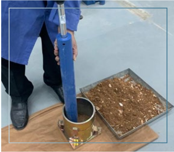
شكل رقم (4): اختبار بروكتور المعدل M.P.T.
