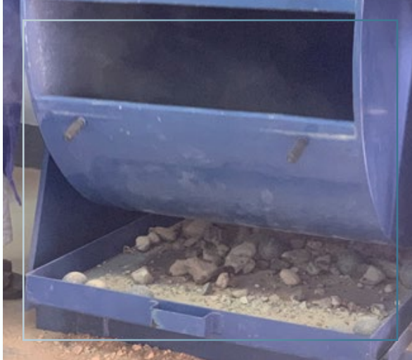
شكل رقم (5): اختبار مقاومة الركام للبري Los Angeles Abrasion Test
