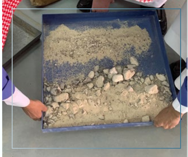
شكل رقم (5): اختبار مقاومة الركام للبري Los Angeles Abrasion Test
