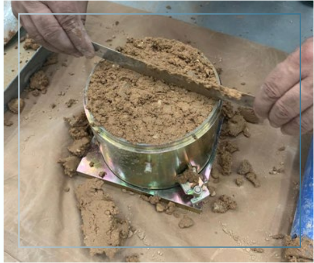
شكل رقم (4): اختبار بروكتور المعدل M.P.T.
