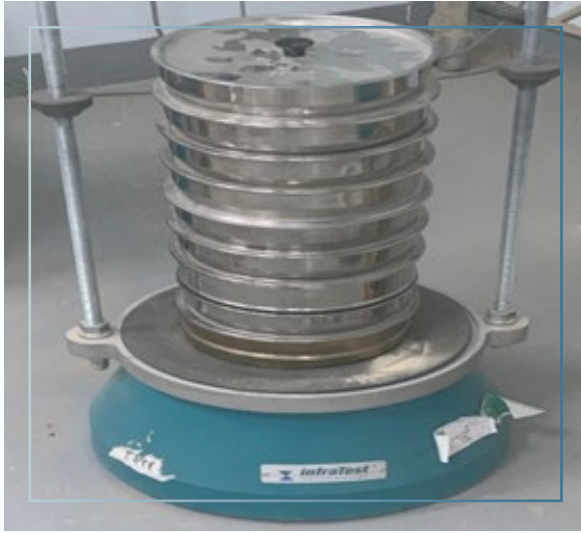
شكل رقم (2): اختبار التدرج الحبيبي Sieve Analysis
